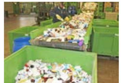
Sortierung von Medikamenten mittels Sortieranlage
