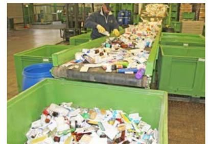
Sortierung von Medikamenten mittels Sortieranlage
