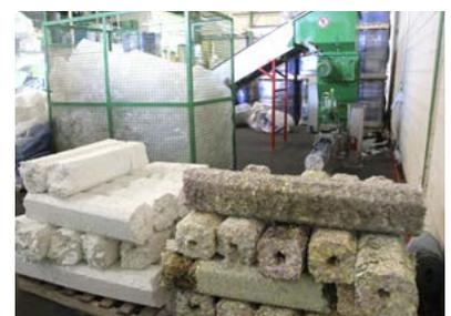
Verdichter für Styropor® und Schäume
