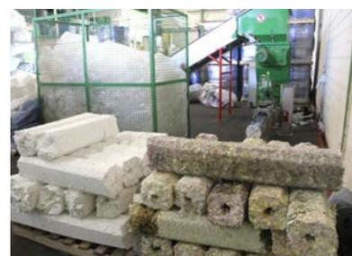
Compression du Styropor® et des mousses
