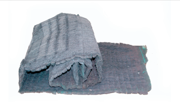
filtres de cabine de peinture
